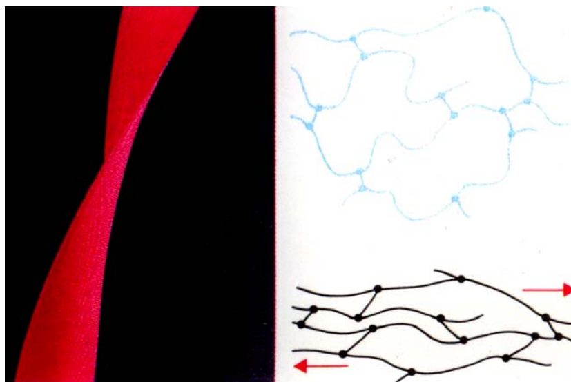
Obr. 23. Elastomer, který obsahuje mírně zesíťované řetězce a vlivem vnější síly dochází k jeho deformaci, která je vratná (zveřejněno se svolením nakladatelství Scientia, Praha)
