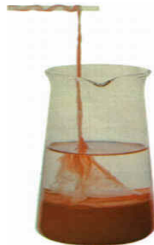
Obr. 13. Schéma polykondenzační reakce při přípravě nylonu 66
